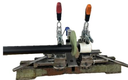
Spiegelschweissanlage für PE Rohre
